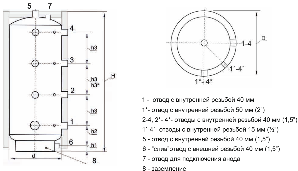
Рисунок 1. Схема подключения теплоаккумулятора серии ТА
