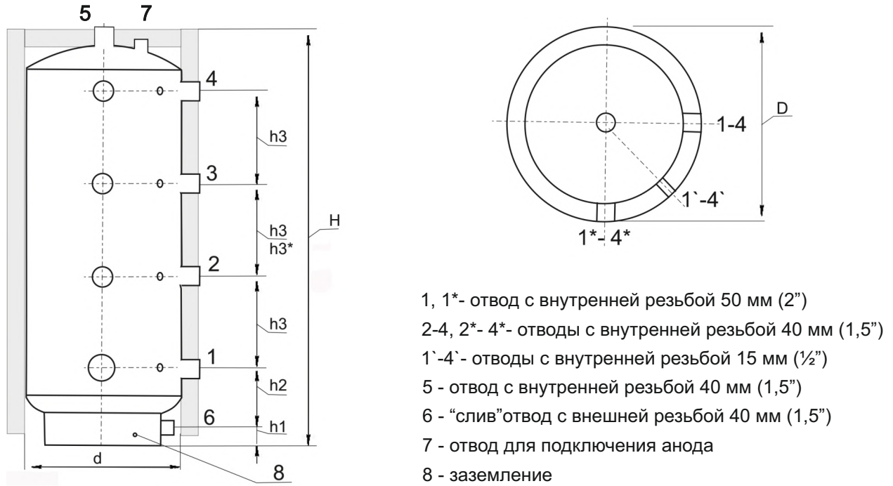
Рисунок 1. Схема подключения теплоаккумулятора серии ТА
