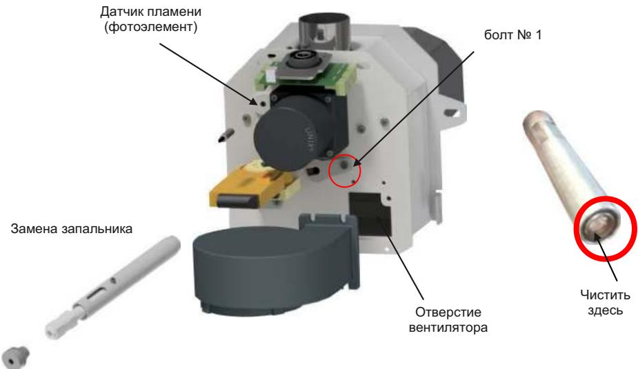
Рисунок 6 - Схема демонтируемых узлов для очистки и ревизии
