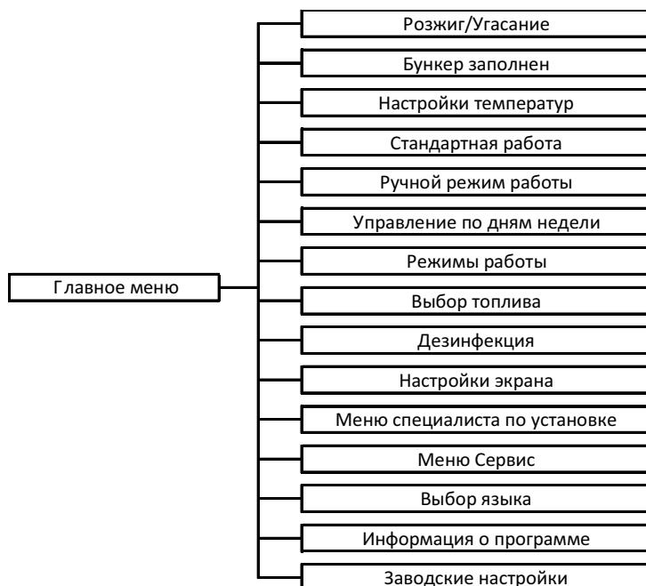
➤ Розжиг/ Затухание: данная функция используется для начала процесса розжига или затухания Горелки. Детальное описание процесса розжига/затухания содержится в разделе «Фазы работы Контроллера»
