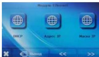
Процесс установки и обслуживания интуитивно понятен. После правильного подсоединения модуля в меню специалиста по установке главного контроллера следует включить Интернет-модуль (**Меню>> Меню специалиста по установке>> Модуль сети Интернет>> Включить**) – после включения опции Регистрация будет сгенерирован регистрационный код, который следует указать на открывшейся странице.
